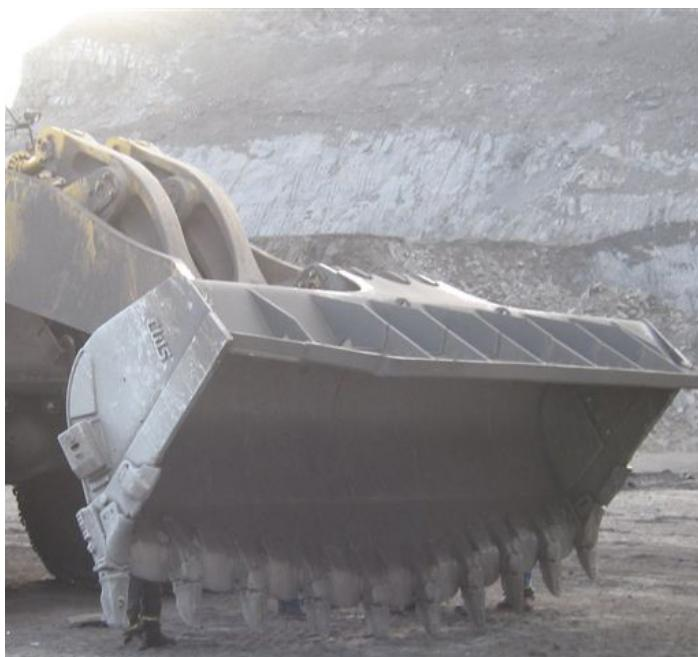
Conocidos por ofrecer el mayor tamaño de su clase, los cucharones para cargadores de ruedas CWS® están diseñados para ofrecer el máximo rendimiento en todas las aplicaciones mineras habituales. Los cucharones de alta capacidad tienen un diseño abierto que permite cargar y descargar materiales fácilmente con mínimo derrame y una resistencia superior. Cuchillas atornillables disponibles.
