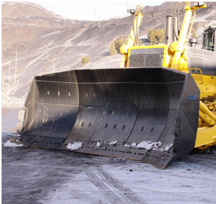
Las hojas de empuje de alta capacidad y alta producción presentan un diseño innovador con rendimiento y calidad demostrados. La serie de hojas de empuje CWS® ofrece una gama completa de hojas duraderas para instalar en tractores de oruga, excavadoras y compactadoras de ruedas, cargadoras de ruedas y niveladoras. Cuentan con paquetes de revestimiento de alta calidad contra el desgaste, protección de la placa lateral, protectores contra derrames y bordes atornillables.
