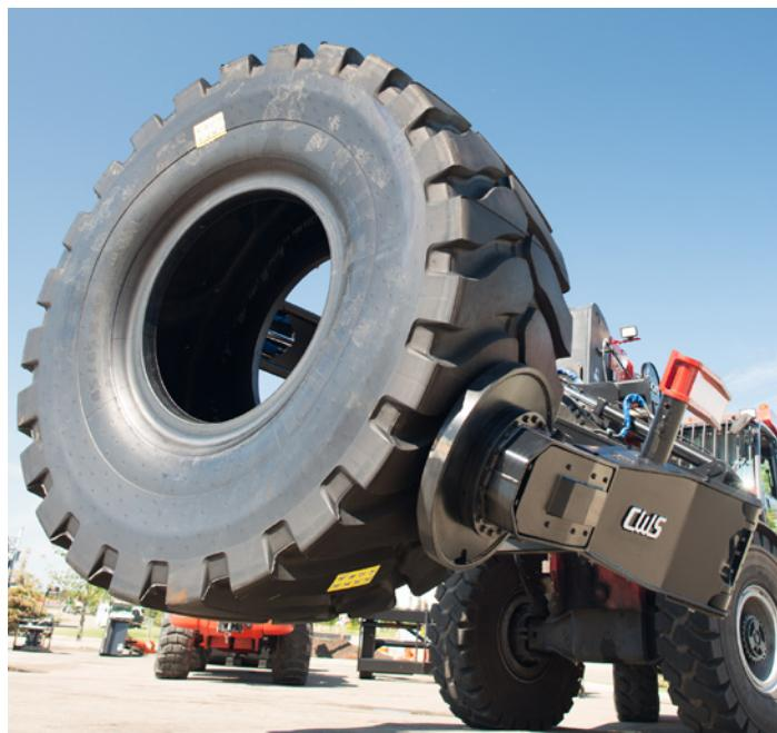
A CWS® é conhecida e respeitada pelas soluções de manuseio de pneus que tem, projetadas para montagem em uma ampla variedade de máquinas para diversas aplicações. Com confiabilidade comprovada pelo setor, o robusto Manipulador de Pneus está disponível em sete capacidades padrão para manusear pneus com segurança.
