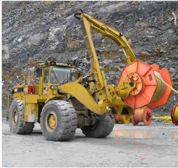
Los sistemas de enrollado de cable CWS® están revolucionando la manipulación de cables eléctricos. Un sistema de despliegue y recolección de cables de alta resistencia para operaciones a cielo abierto y subterráneas. Cuenta con una estructura robusta y está diseñado para facilitar el mantenimiento y simplificar el funcionamiento.
