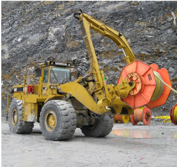
Os sistemas de enrolamento de cabos CWS® estão revolucionando o manuseio de cabos elétricos. Um sistema de recolhimento/recuperação de cabos para serviços pesados em operações subterrâneas e a céu aberto. Construído de forma robusta e projetado para facilitar a manutenção e simplificar a operação.
